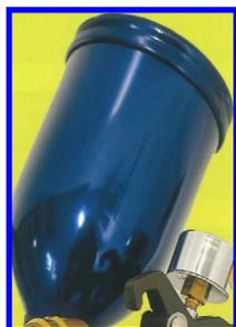
PAC530-9はスプレーガンと専用カップでのセット販売です。ブルーアルマイトを施したアルミ製を採用し軽量化を実現しています。塗料経路はコーナー部をラウンドさせ、且つシーム(つなぎ目)の段差を少なくする工程を採用。またカップの排出口を大口径にすることで水性などの高粘度塗料もスムーズに流れるよう対応しています。
