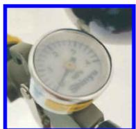
同じくPACガンシステムの肝である空気圧管理。最大圧力0.4MPaの超小型圧力計を採用し、微動指針式表示はにより微妙なエア流動圧力の調整や確認が素早く行えます。(仕様設定の各数値はエア圧力0.2MPaでの数値となっています)
