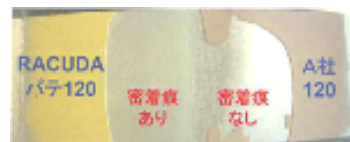
輸入車防錆鋼板 100℃×1時間乾燥後の折曲げ試験 *当然パテは割れますが、ラクーダは鋼板に密着痕がしっかり残っており耐熱密着性が良好です。
